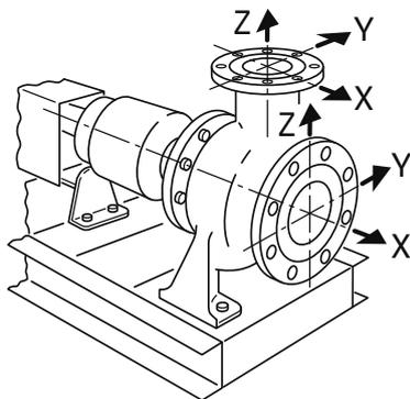
Fig. 11: Sallitut voimat ja momentit pumpun laippojen yhteydessä – valurautainen pumppu
