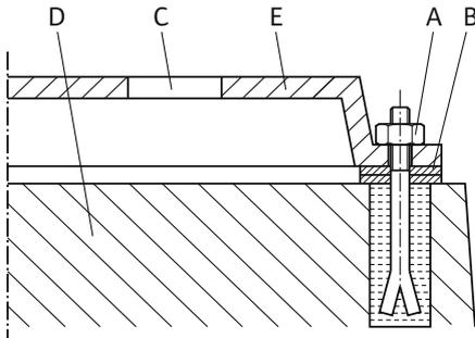
Fig. 15: Przykład połączenia śrubowego z fundamentem
