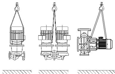
Fig. 6: Транспортировка насоса
