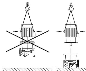
Fig. 7: Транспортировка электродвигателя
