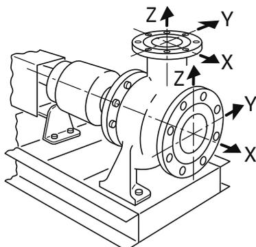
Fig. 11: Tillåtna krafter och moment på pumpflänsarna - gjutjärnspumpar
