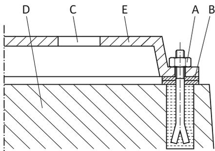
Fig. 15: Exempel på ett skruvförband för fundamentet
